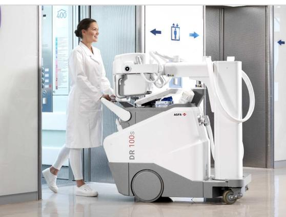
Röntgenaufnahmen direkt am Krankenbett sind für Anwender und Patienten gleichermaßen komfortabel. Die ZeroForce-Technologie sorgt dafür, dass die Röhre in allen drei Achsen nahezu ohne Kraftaufwand gedreht werden kann. Das 10 Zoll-Touchdisplay an der Röhreneinheit ermöglicht Einstellungsänderungen direkt am Patientenbett und den Zugriff auf Patientendaten, Generator-einstellungen und Bildvoransichten.
